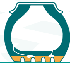
Migratie van lucht vindt doorgang en uitbreiding
